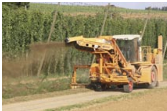
Bankettfräse SBF 900 beim seitlichen Auswerfen des Fräsgutes
