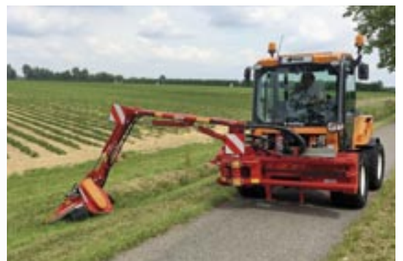
Der MBM 400 mit Mähkopf MKT am Multihog
