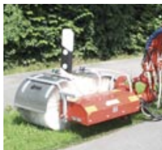
LPW 500 Leitpfosten und Schilderwaschanlage Arbeitsbreite: 500 mm Drehzahl: max. 375 U/min Gewicht: 150 kg
