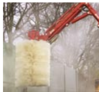
SWA 900 Schilderwaschanlage Bürstenbreite: 900 mm Bürstendrehzahl: 250 U/min Gewicht: 155 kg
