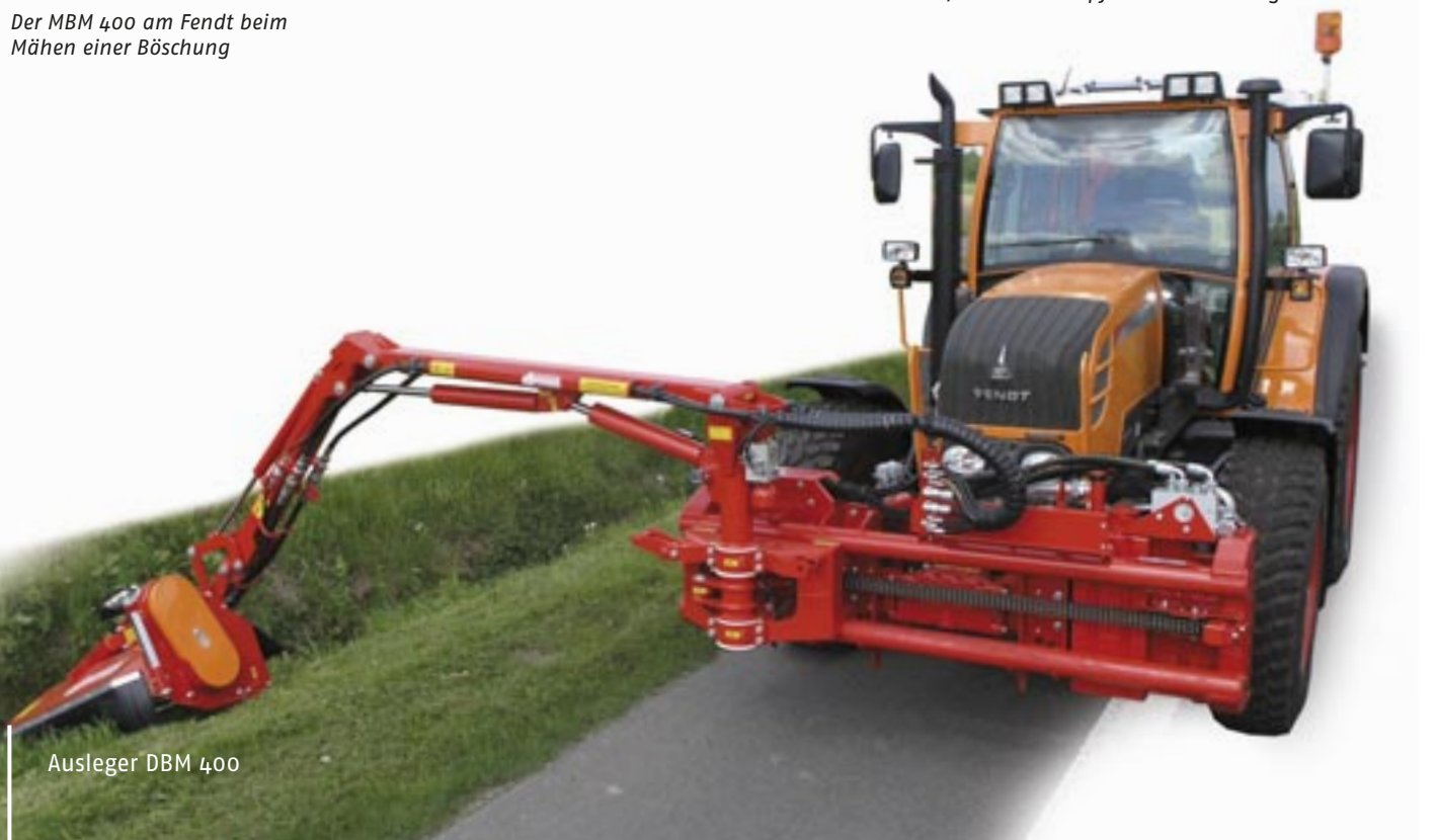
Der MBM 400 mit Mähkopf MKT am Multihog
