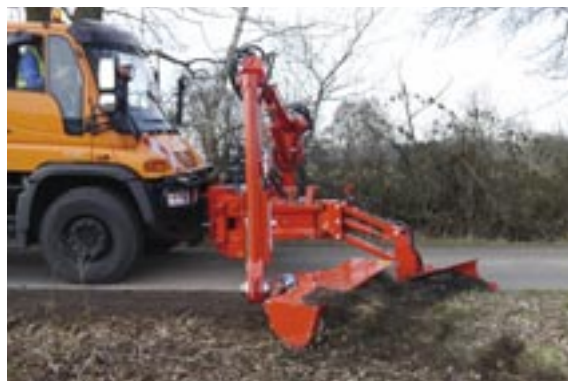
Banketträumschnecke BRS 15 im Einsatz
