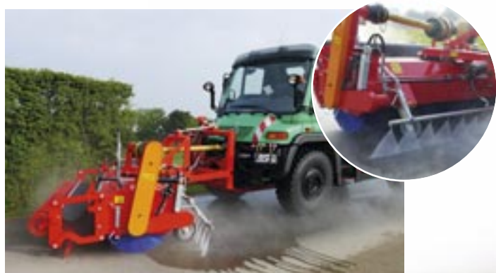
SFK mit Aufkratzleiste, Wasserhochdruckanlage und Schwemmbalken
