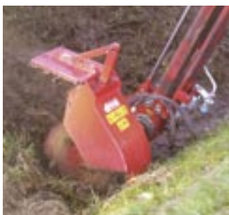
GSF 600 Grabensohlenfräse Fräsdurchmesser: 600 mm Rotordrehzahl: 800 U/min Gewicht: 230 kg
