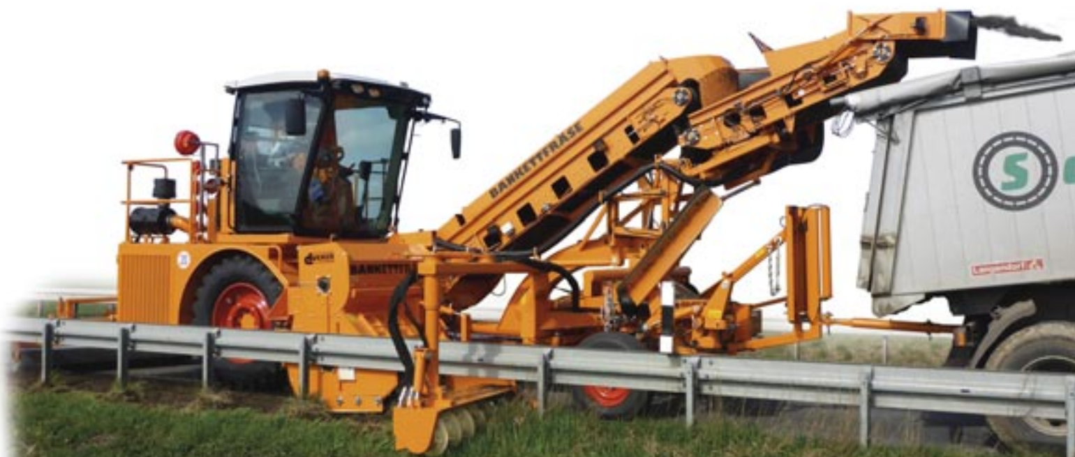
Bankettfräse SBF 900 beim seitlichen Auswerfen des Fräsgutes
