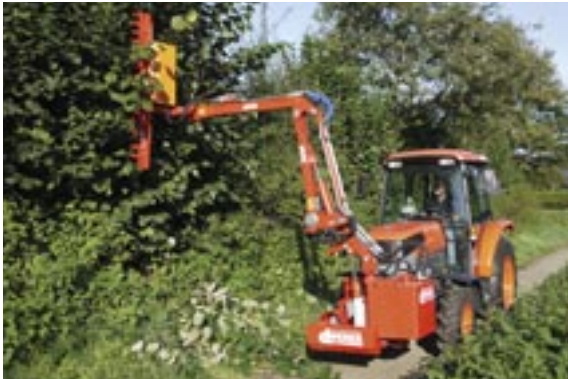
KBM 350 mit Heckenschere, Frontanbau, Arbeitsseite rechts
