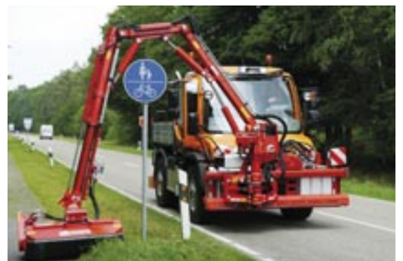
DUA 800 - Der Teleskoparm ermöglicht das Überfahren von Verkehrszeichen.
