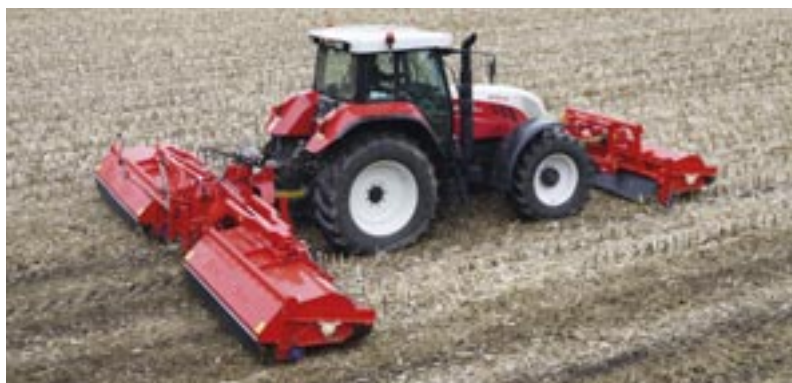
GFM 740 in aufgelöster Bauform
