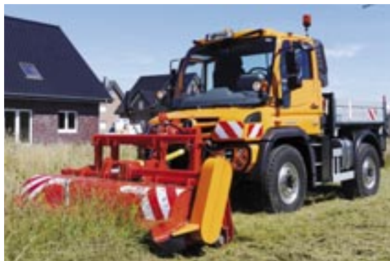
UM 27 Frontanbau mit Verschiebung
