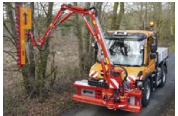
Der DUA 700 mit AWS 22 am Unimog
