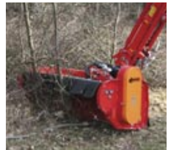
GMK 12 Gestrüppmähkopf Arbeitsbreite: 1200 mm Schnittstärke: bis 60 mm Rotordrehzahl: 2700 U/min Gewicht: 350 kg
