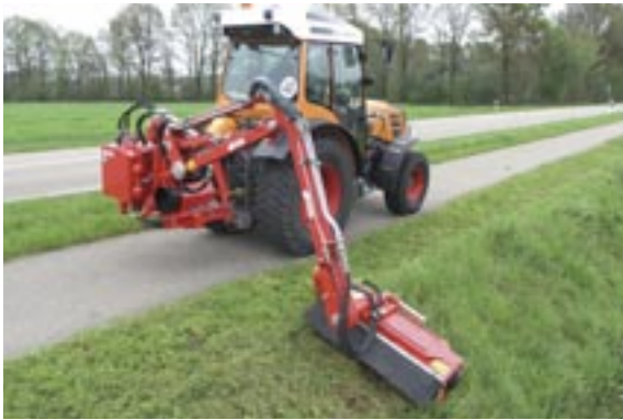
KBM 350 mit Schlegelmähkopf, Heckanbau, Arbeitsseite rechts
