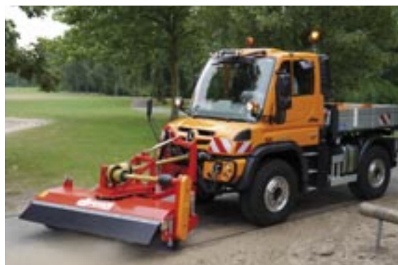
FKM mit Antrieb über Gelenkwelle
