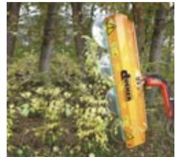
LPS 20 Lichtraumprofilsäge Arbeitsbreite: 2000 mm Sägeblattdrehzahl: 2600 U/min Gewicht: ca. 220 kg
