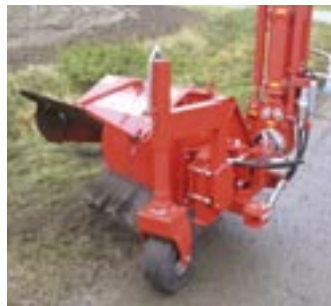
RWB 600 Radialwildkrautbürste Arbeitsbreite: 600 mm Rotordrehzahl: 150 U/min Gewicht: 320 kg
