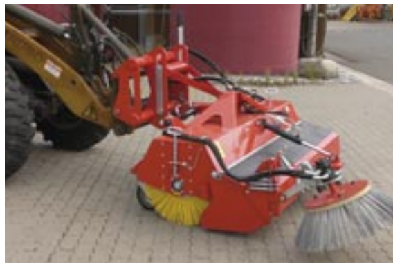
HDK mit Seitenbesen im Einsatz
