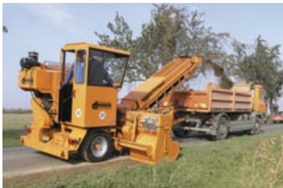
Bankettfräse BF 800 mit Aussenschnecke
