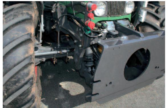
Fahrzeugplatte mit hydraulischer Achsabstützung
