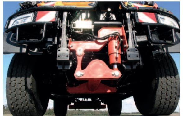
hydraulischer Torsionsrahmen am Unimog
