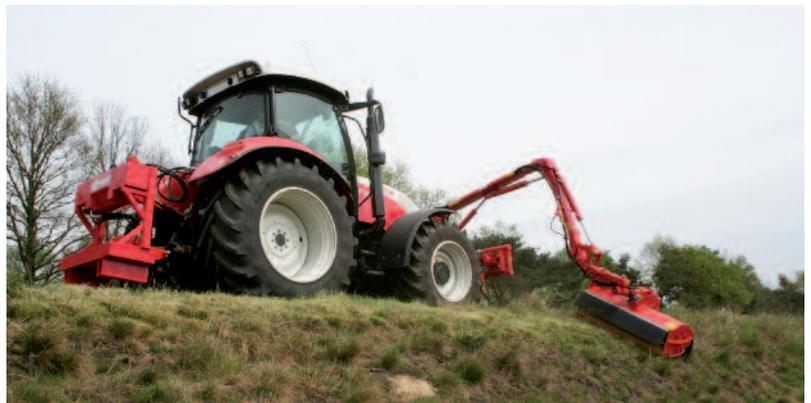
UNA 500 in geteilter Bauform (Hydraulikaggregat im Heckanbau)
