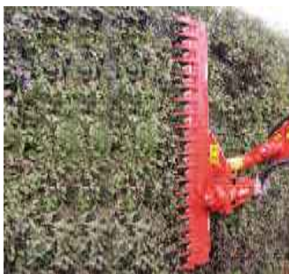
HSL 15 Heckenschneider Arbeitsbreite: 1500 mm Schnittstärke: bis 30 mm Gewicht: ca. 85 kg
