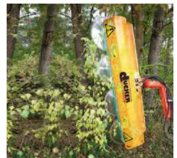
LPS 20 Lichtraumprofilsäge Arbeitsbreite: 2000 mm Sägeblattdrehzahl: 2600 U/min Gewicht: ca. 220 kg
