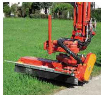
TTM 13 Schlegelmähkopf Arbeitsbreite: 1300 mm Rotordrehzahl: 2800 mm Gewicht: 270 kg
