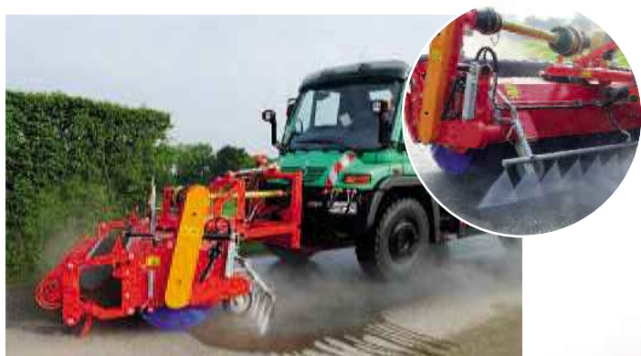
SFK mit Aufkatzleiste, Wasserhochdruckanlage und Schwemmbalken
