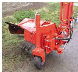
RWB 600 Radialwildkrautbürste Arbeitsbreite: 600 mm Rotordrehzahl: 150 U/min Gewicht: 320 kg
