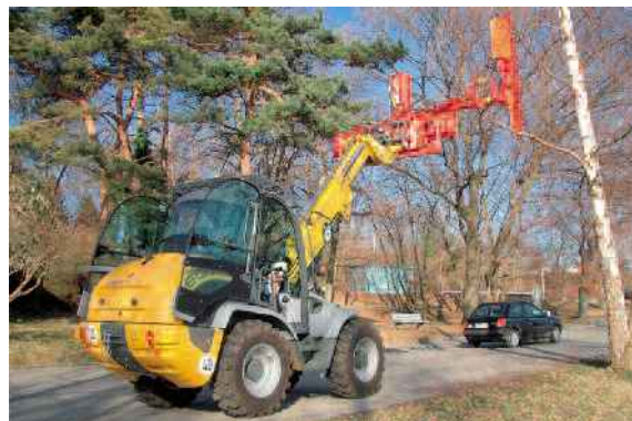
Ast- und Wallheckenscheren, kpl. mit Frontladerverschieberarm für die Frontladeraufnahme nach Euro-Norm, einschließlich hydraulischer und elektro-hydraulischer Steuerung, rechtsarbeitend. Verschiebung um 1,60 m, Ausweichvorrichtung
