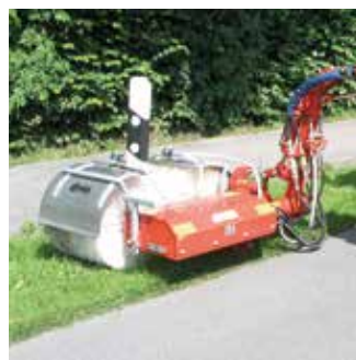
LPW 500 Leitpfosten und Schilderwaschanlage Arbeitsbreite: 500 mm Drehzahl: max. 375 U/min Gewicht: 150 kg
