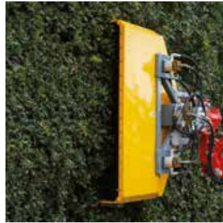
HS 130 HR Heckenschneider Arbeitsbreite: 1300 mm Schnittstärke: bis 25 mm Gewicht: 165 kg
