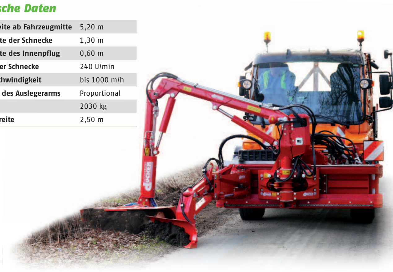
Banketträumschnecke BRS 15 in Transportstellung
