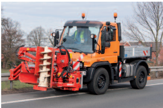
Banketträumschnecke BRS 15 in Transportstellung
