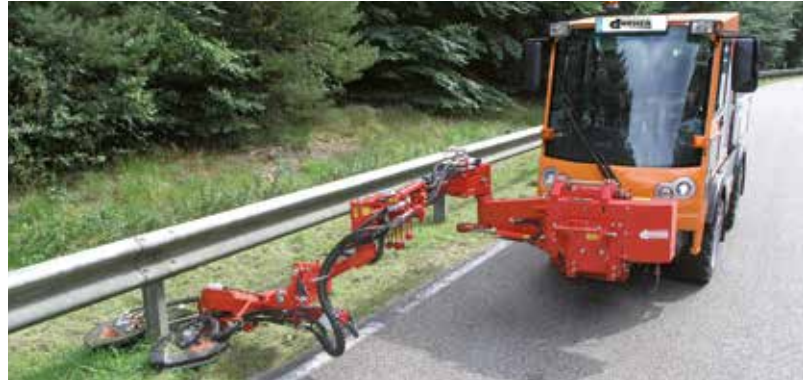
MGK 13 mit Leitpfostenmäher LSM
