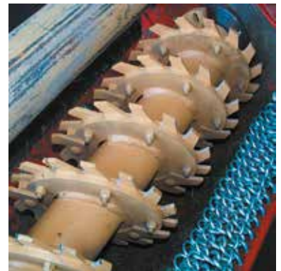
Taumelscheibenwelle des RSM 13
