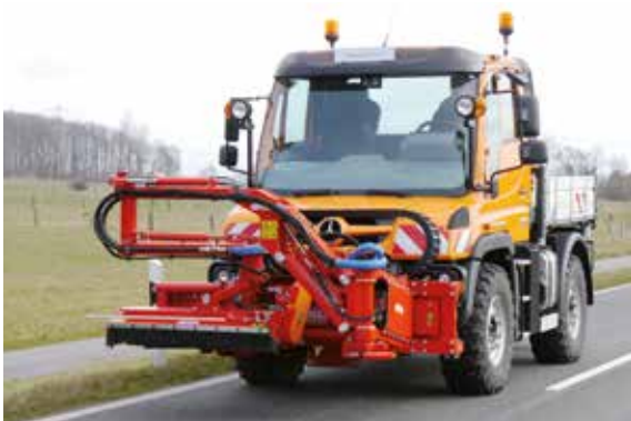
Der Randstreifenmäher RSM 13 in Transportstellung
