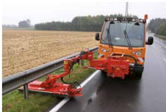
MGK 13 beim Mähen unter Leiteinrichtungen
