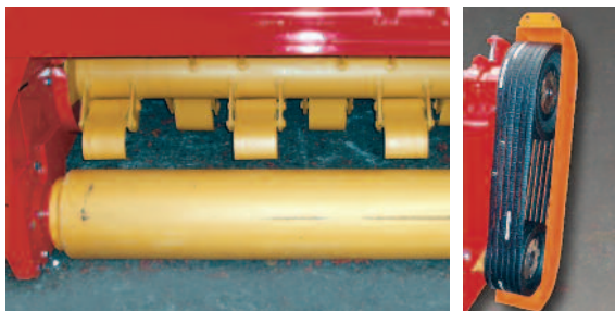
Schlegelwelle, Laufrolle und Keilriemenantrieb
