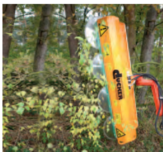
LPS 20 Lichtraumprofilsäge Arbeitsbreite: 2000 mm Sägeblattdrehzahl: 2600 U/min Gewicht: ca. 220 kg
