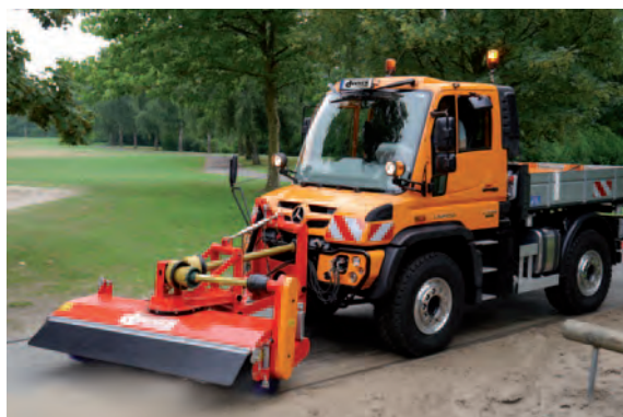
FKM mit Antrieb über Gelenkwelle
