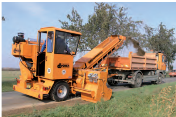
Bankettfräse BF 800 mit Aussenschnecke
