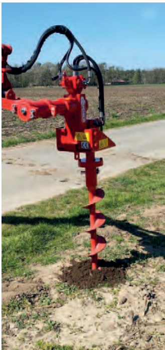
Erdbohrer bestückt mit Bohrspitzen und Schneidzähnen, zum Setzen von Leitpfosten usw. Ø 100 mm, Länge 1200 mm Ø 150 mm, Länge 1200 mm Ø 300 mm, Länge 1200 mm Ø 400 mm, Länge 1200 mm
