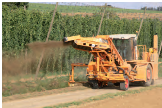
Bankettfräse SBF 900 beim seitlichen Auswerfen des Fräsgutes
