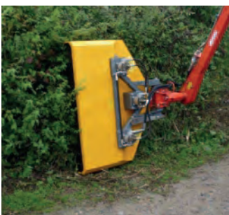
HS 130 HR Heckenschneider Arbeitsbreite: 1500 mm Schnittstärke: bis 20 mm Gewicht: ca. 140 kg
