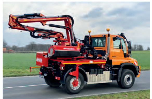
Transportstellung des Aufbauauslegers DAM
