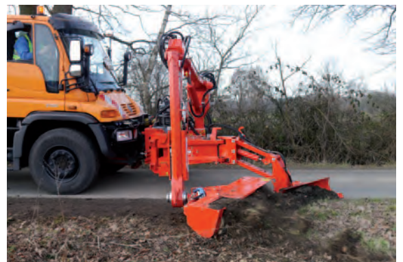
Banketträumschnecke BRS 15 im Einsatz
