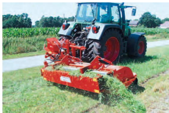
USM mit Förderband zur seitlichen Auslage des Mähgutes
