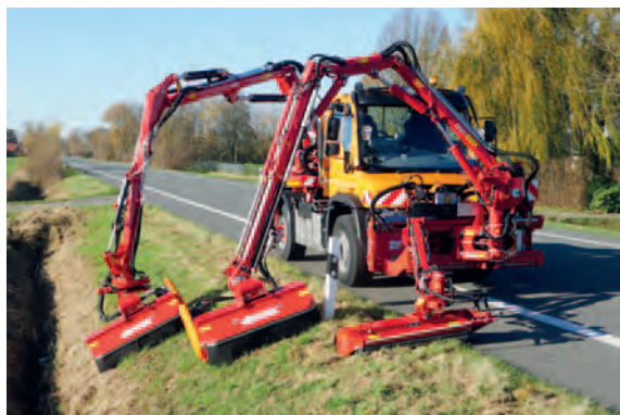
Aufbauausleger DAM mit MK 25/800
