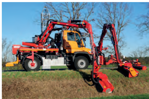
Die Mähkombination mit drei Mähköpfen ermöglicht die Mahd von 3 Schnitten in einem Arbeitsgang
