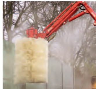
SWA 900 Schilderwaschanlage Bürstenbreite: 900 mm Bürstendrehzahl: 250 U/min Gewicht: ca. 155 kg
