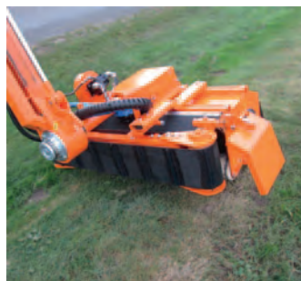
VMS mit Förderband mit hydraulischem Antrieb
