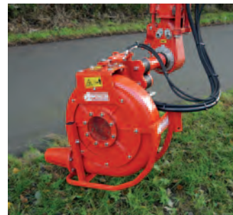
LG 90 Laubgebläse Luftkapazität: ca. 90 m 3 /min. Gewicht: ca. 160 kg
