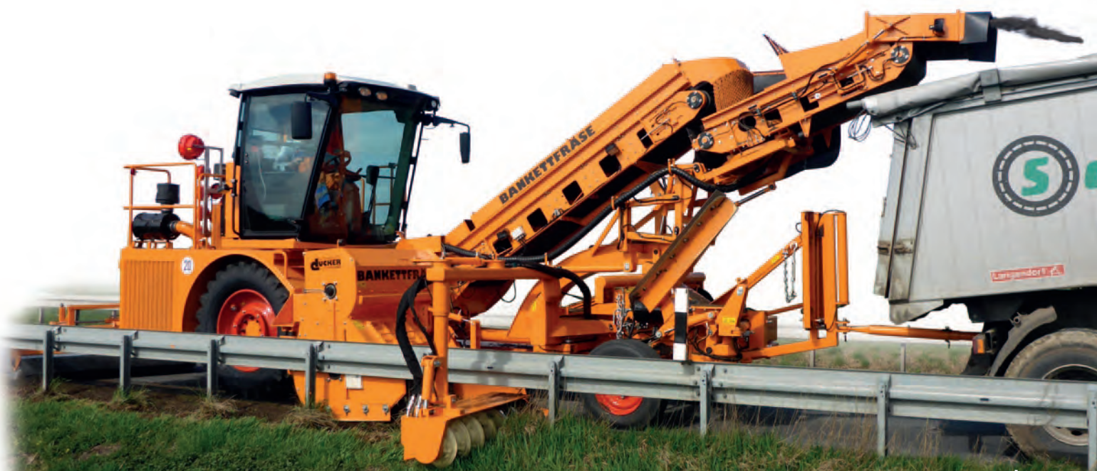
Bankettfräse SBF 900 beim seitlichen Auswerfen des Fräsgutes
