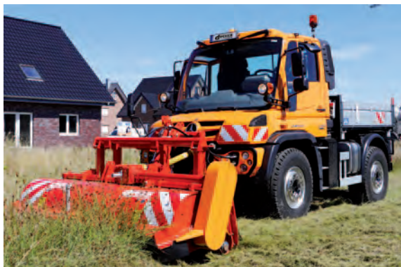
UM 27 Frontanbau mit Verschiebung
