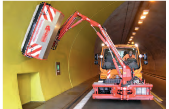
Ausleger DUA 800 mit Tunnelwaschanlage
