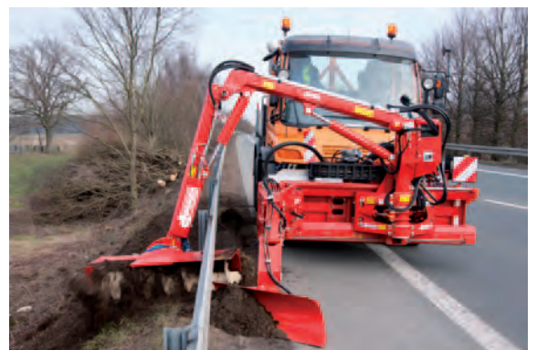
BRS 15 im Einsatz an Leiteinrichtungen
