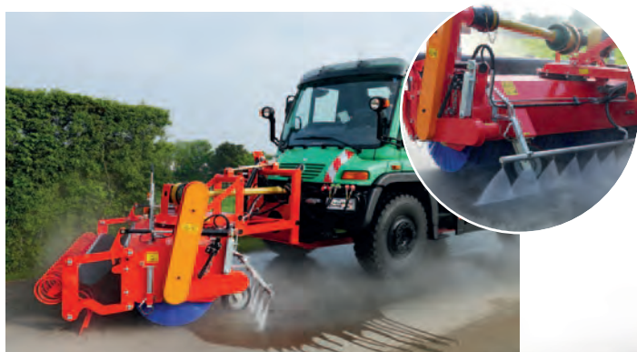
SFK mit Aufkratzleiste, Wasserhochdruckanlage und Schwemmbalken
