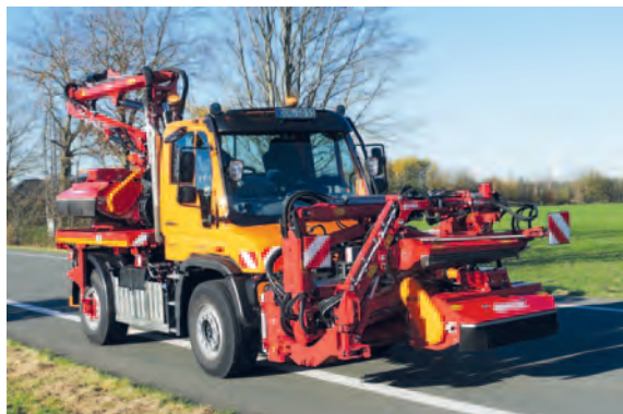
DAM als Mähkombination in Transportstellung
