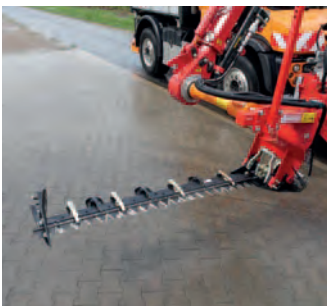
DMW 15 Doppelmesserschneidwerk Arbeitsbreite: 1500 mm Gewicht: ca. 110 kg
