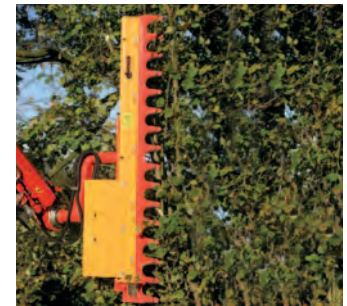
AWS 13 / 22 Ast- und Wallheckenschere Arbeitsbreite: 1300/2200 mm Schnittstärke: bis 110 mm Gewicht: ca. 160 kg / 230 kg
