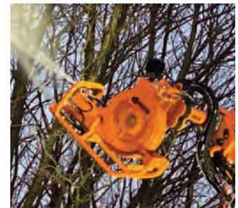
Gebläse mit Sprühvorrichtung Reichweite: bis 30 m Höhe Gewicht: ca. 110 kg
