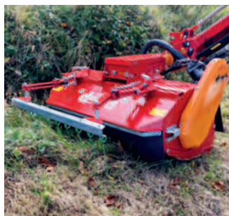
VMS 1200 Öko Öko-Mähkopf Arbeitsbreite: 1220 mm Rotordrehzahl: 2400 U/min Gewicht: ca. 320 kg
