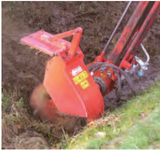
GSF 600 Grabensohlenfräse Fräsdurchmesser: 600 mm Rotordrehzahl: 800 U/min Gewicht: ca. 230 kg
